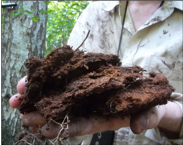
Bohrpunkt Gbs02: Degradierter Oberboden mit L+Of- (+4 cm) und Hav-Horizonten (0-12 cm)(links) sowie Ht-Horizont (12-24 cm)(rechts).
