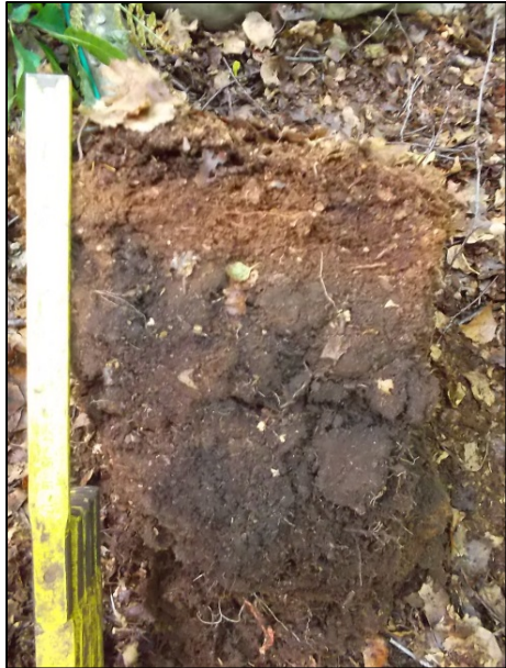
Bohrpunkt Gbs02: Degradierter Oberboden mit L+Of- (+4 cm) und Hav-Horizonten (0-12 cm)(links) sowie Ht-Horizont (12-24 cm)(rechts).
