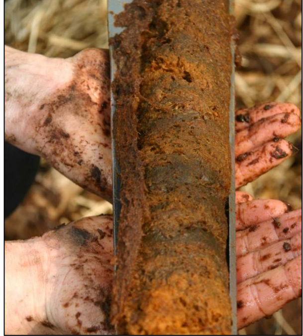
Ganzjährig trockener, degradierter Oberboden der Moorrandzone im Teufelsfenn (15 cm uHv über uHt; Gtf15, links). Wechsellagerung von Braunmoostorf und Detritusmudde in ca. 6 m Tiefe (Moorzentrum, Gtf03, rechts).
