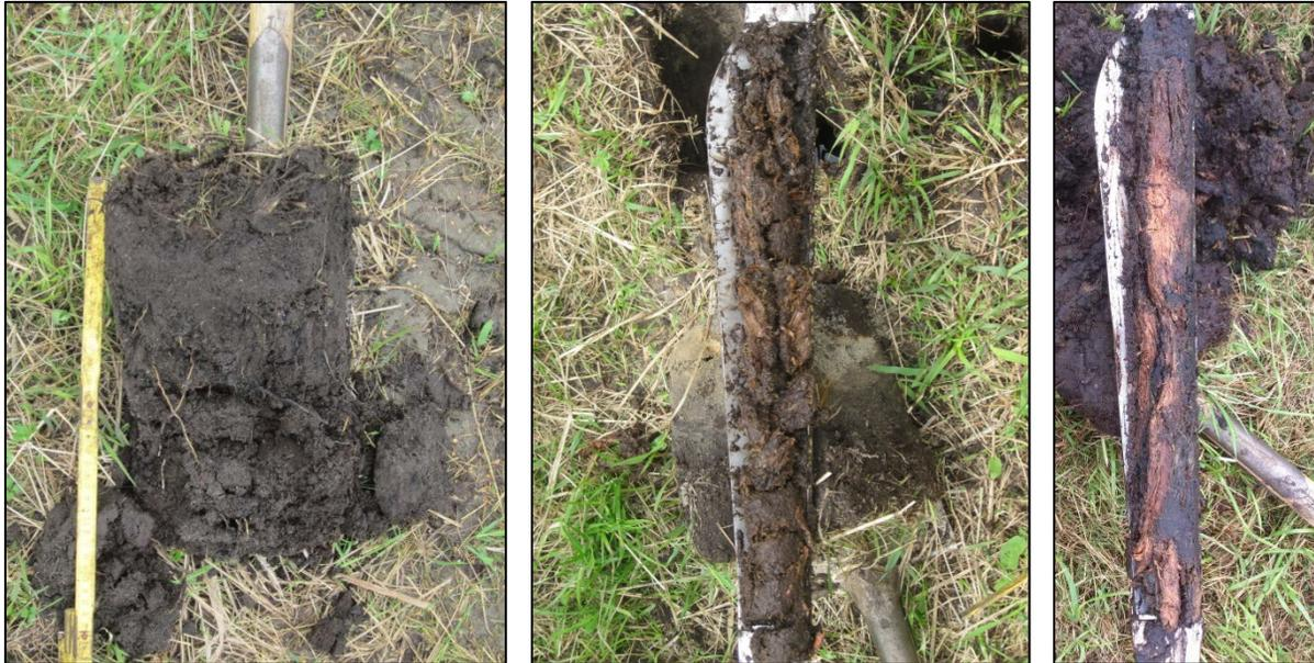
Durch Sandeinmischung anmooriger Oberboden (Tlu09, links) unter Wiesennutzung, mittel bis stark zersetzter Schilf-Radizellentorf aus 1–1,50 m Tiefe desselben Profils (Mitte); Erlenbruchtorf aus 1,50–2,00 m Tiefe (Tlu15, rechts), Foto: Lobik (2013).
